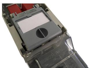
Untere Beschriftungsklappe flach oberhalb der Anschlussraumabdeckung.
