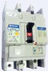
Die zur Verfügung stehende Kurzschlussleistung von Generatoren ist niedriger als typische Transformatoren. Manchmal sind MCCBs mit empfindlicher unverzögertem Schutz für die Verwendung mit Generatoren notwendig.
