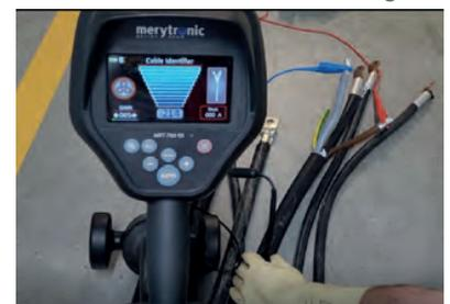
Anzeige der Kabelkennzeichnungsfunktionalität
