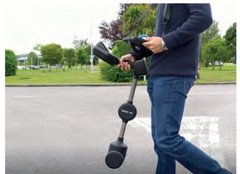
*Hinweis: Der MRT-700 wird auch von Topografieunternehmen verwendet, wenn eine extrem hohe Genauigkeit erforderlich ist, indem das Gerät an ein externes GPS angeschlossen wird.*
